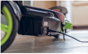
Abb. 18: Aufladen eines eRollers mit einem externen Batterieladegerät.
