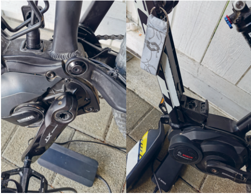
Abb. 15: Laden mit (rechts) und ohne (links) Batterieentnahme.
