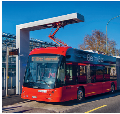
Abb. 22: Das Gelegenheitsladen findet typischerweise an den Haltestellen statt und zeichnet sich durch eine hohe Leistung und Pantographenverbindung aus (Quelle: luzernerzeitung.ch, eBus Zug).
