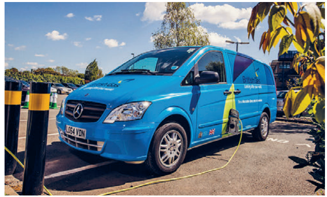
Abb. 10: Beim Mercedes-Benz Van (2018) ist die Anschluss-Position am Ende der Fahrertür, ungefähr gegen Automitte, Pos. 7 bei einem normalen Fahrzeug.
