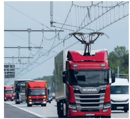
Abb. 23: Eine Lösung für das Lkw- Gelegenheitsladen besteht darin, Strassenabschnitte mit einer Luftlinie zu versehen, an der Lkws mit einem Stromabnehmer angeschlossen werden können (Quelle: handelsblatt.com, eLKW Pantograph eHighway).
